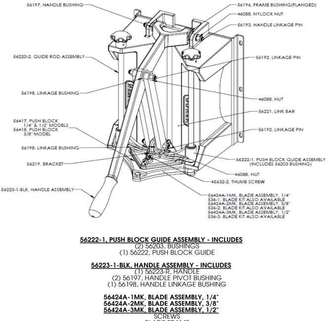
**BLADE FRAME BLADE PLATE BLADE PLATE SPACERS BLADE SPACERS** BLADES
